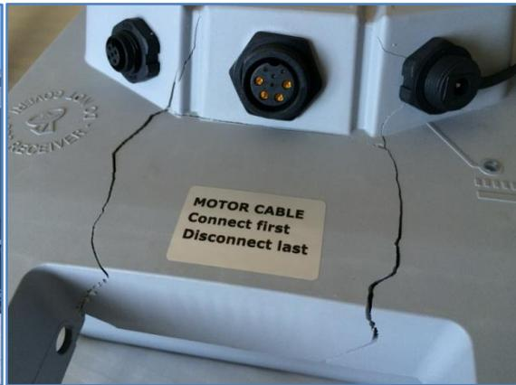
La batterie est sérieusement endommagée. On teste la batterie et à notre grand surprise tout fonctionne... Torqeedo, c'est du solide ! Ils nous faut donc réparer le boîtier endommagé. Nous trouvons une colle à très haute résistance et surtout, étanche. Nous y passons l'après-midi mais nous réparons la batterie.
